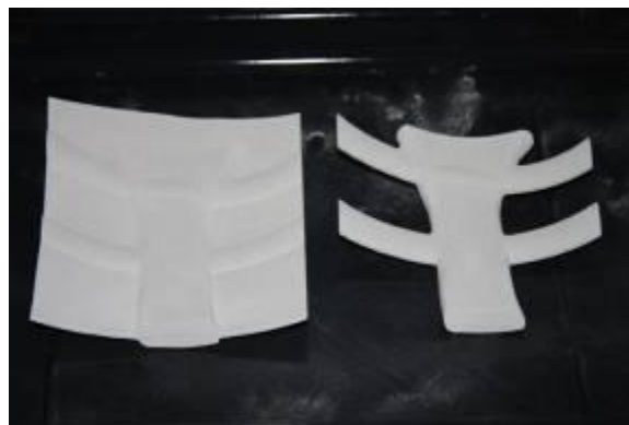
Слика 9. Готови оригинали добијени поступком 3D штампања
